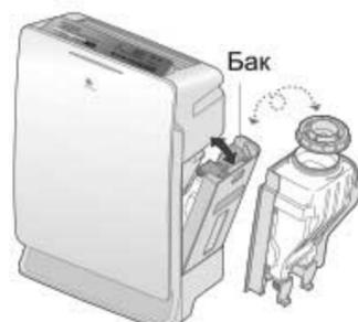
Верхнее положение и нижнее положение бака должны поменяться при заполнении его водой и установке его обратно.
