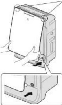
Задвиньте выступ в отверстия (2 места) прибора и нажмите надлежащим образом.
