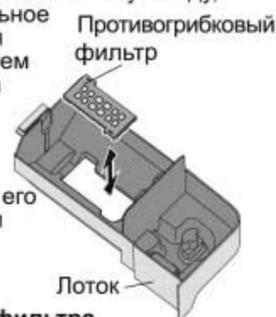
**■ Функции противогрибкового фильтра**
