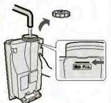
3 Чтобы предотвратить утечки, надежно закрутите крышку ёмкости.
