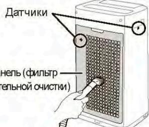
Аккуратно удалите пыль с помощью инструмента для очистки (например, пылесоса).
