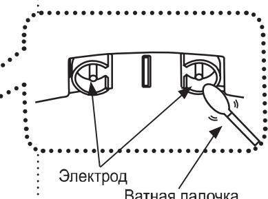
**4** После чистки генератора плазменных ионов соберите вентилятор в обратном порядке разборки.
