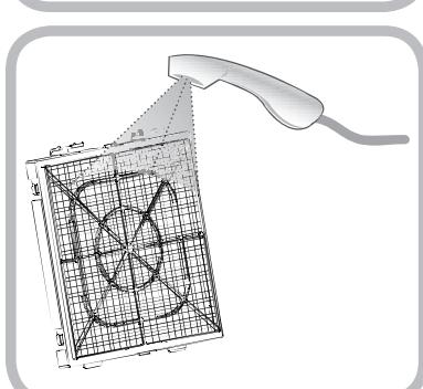
**4** Промойте водой из душа после промывания пылевого фильтра губкой с растворенным моющим средством.
