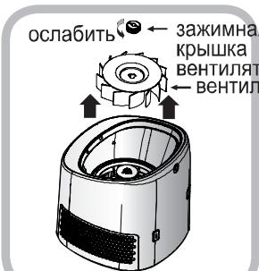
**2** Снимите зажимную крышку вентилятора, повернув ее против часовой стрелки, и отключите вентилятор.
