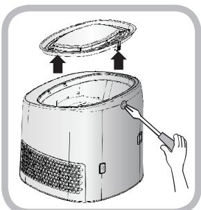
**1** Ослабьте болт на верхней крышке с помощью крестовой отвертки и снимите верхнюю крышку, подняв ее.
