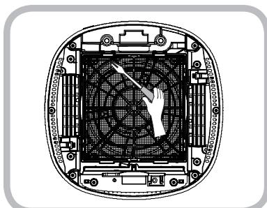
**2** После переворачивания верхней части основного корпуса ослабьте болт на пылевом фильтре с помощью крестовой отвертки
