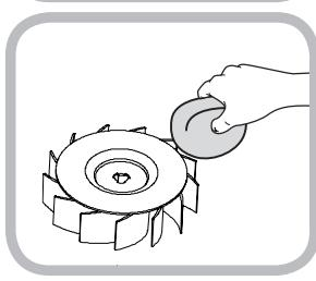
**3** Промойте водой из душа после промывания вентилятора губкой с растворенным моющим средством.
